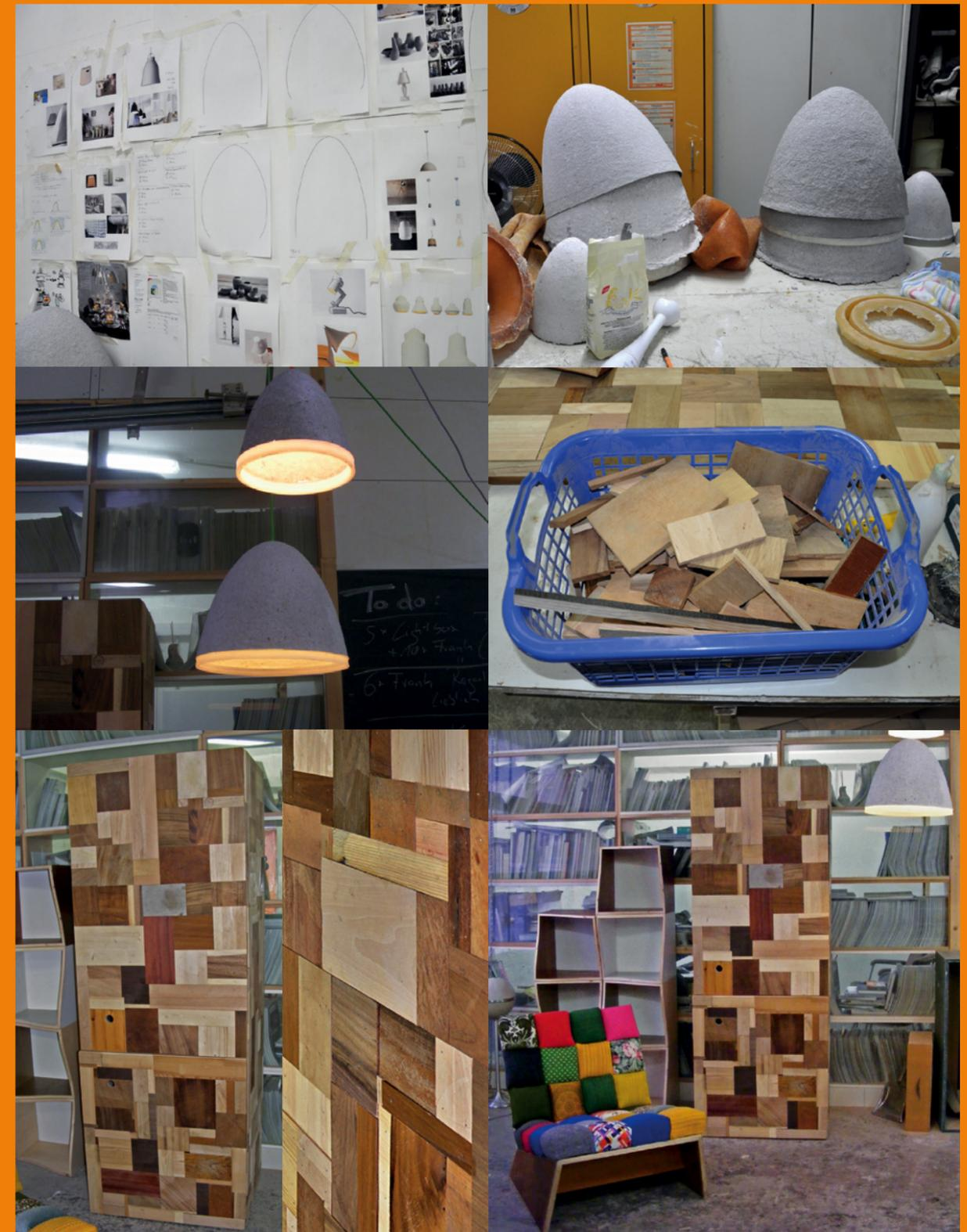
Die Bilder aus Schübbes Werkstatt zeigen den Arbeitsprozess einer Lampe aus zerkleinertem Altpapier (oben) und den eines Sarges aus alten Brettchen bis hin zu den fertigen Möbeln.
