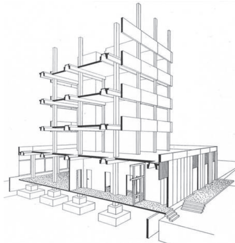
Fig. 3: Konstruktionsperspektive des zentral standardisierten Stahlbetonmontagebausystems "Vereinheitlichter Geschoßbau (VGB)" als Längsriegelbau, Laststufe 5 Mp, ab 1970 DDR-weit eingeführt (© https://www.bbr-server.de/bauarchivddr/finbuch/kataloge/index.htm , Zugriff Oktober 2018).
