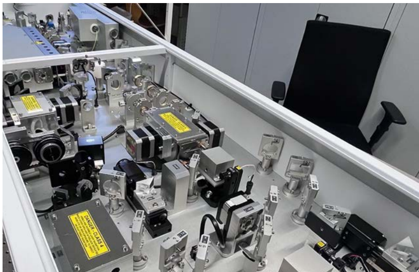
Lasersystem zur wellenlängenabhängigen Fluoreszenzmessung
