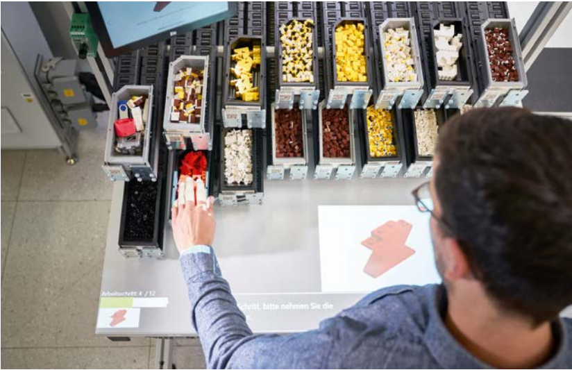
Augmented Reality basierte Assistenz für die Montage Augmented Reality prototype for assembly assistance
