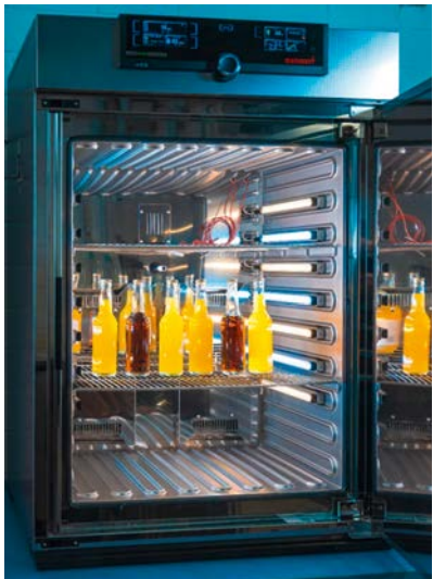
Beschleunigter Haltbarkeitstest in einem Konstantklimaschrank
