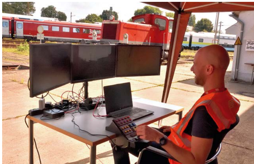
inIT-Mitarbeiter André Bröring bei der Erprobung der Fernsteuerung auf dem Versuchsfeld der DB Systemtechnik in Minden
