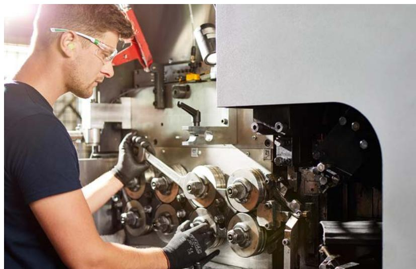
Die erforderliche Qualität und Präzision der Stahlfedern kann nur durch optimal parametrierte Windemaschinen gewährleistet werden.
