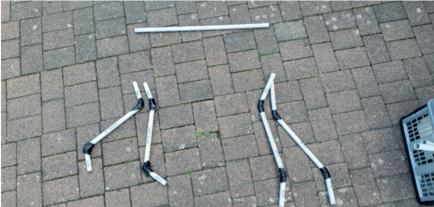
Abb.35: Beine und Wirbelsäule aus PVC-Rohren (Eigene Aufnahme, 2025)
