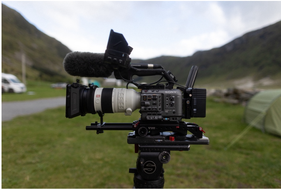
Setup für weiter entfernte Surfaufnahmen bestehend aus der gleichen Kamera aber mit externem Akku, Telezoomobjektiv und Stativ
