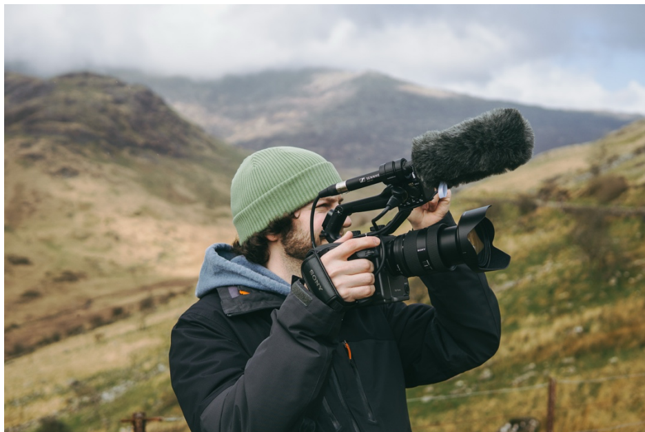
Klassisches und leichtes „Handeld“ Setup bestehend aus der Kamera mit internem Akku, Zoomobjektiv und Shotgun Mikrofon.
