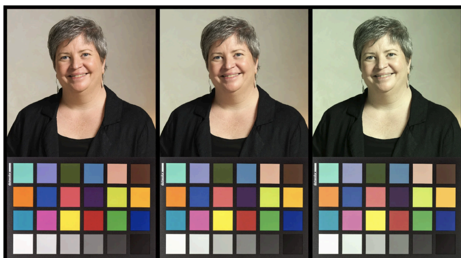
Abbildung 74: Hauttöne unter verschiedenen Lichtspektren mit unterschiedlicher Farbwiedergabequalitäten von Hauttönen (Locke, 2025)
