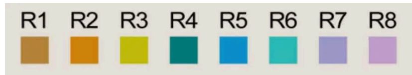
Abbildung 23: CRI Ra und Rg Farbtafeln (GreenLED, 2023)
