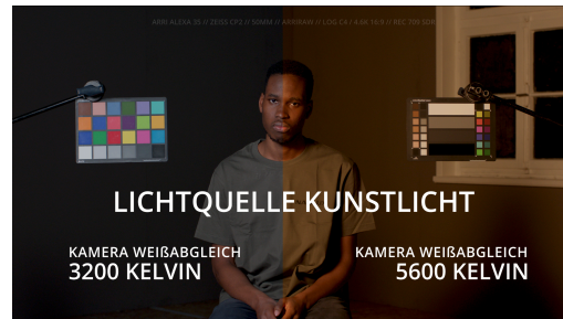
Abbildung 93: Kunstlicht-Set (3200 Kelvin - Leuchtmittel) mit verschiedenen Kamera-Weißabgleich Einstellungen (Eigene Aufnahme)
