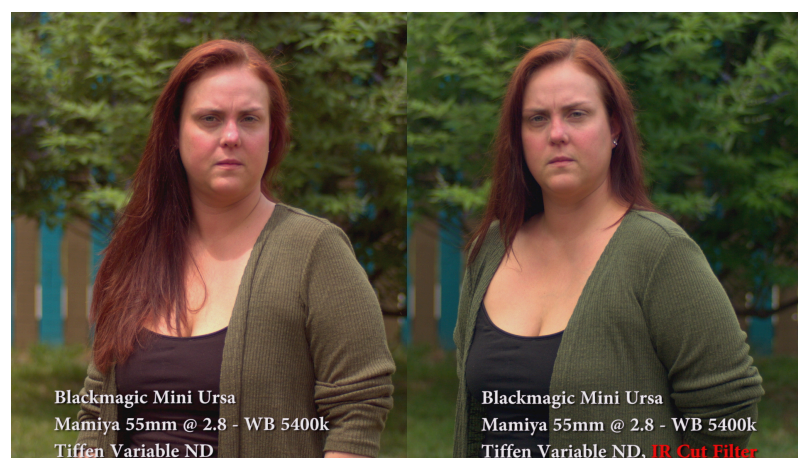
Abbildung 55: ND Filter und sichtbarer IR-Verschmutzung (dunkle Textilien) neben demselben Szenario während der Nutzung eines IR-Cut-Filters. (Gaddis, o. D.)
