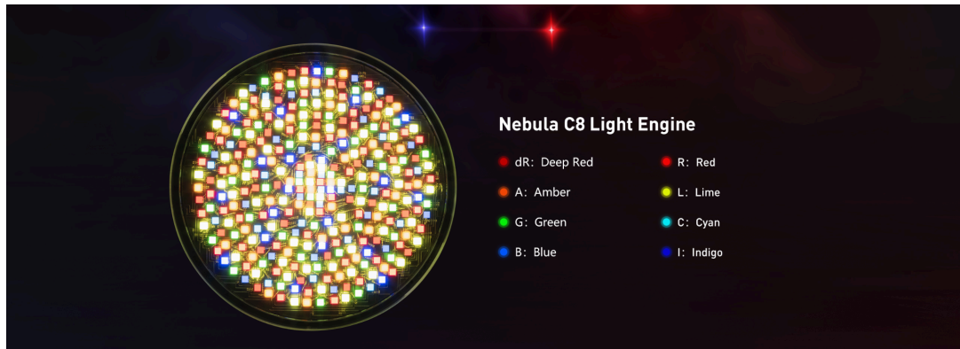
Abbildung 71: Nanlux COB-Chipset mit 8 den verschiedenen LEDs der Nebula C8 Engine. (NANLUX, o. D.)
