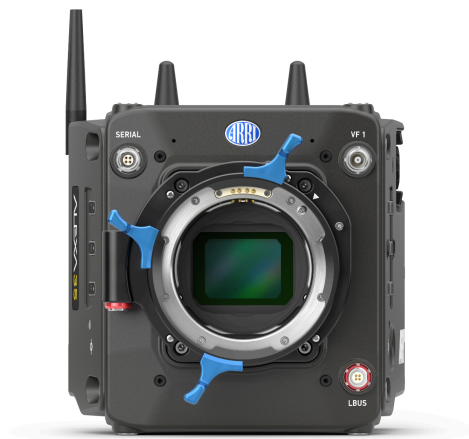
Abbildung 87: Arri Alexa 35 mit ALEV-4 CMOS Sensor (ARRI, o. D.-a)
