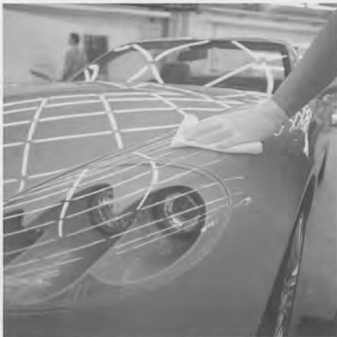
**Abb. 3: Sensorische Prüfung von Hochglanzoberflächen: Endkontrolle Autolackierung (Horvath, 2008)**
