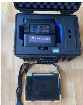
Abb. 35: Unsere Ausrüstung für die 360°-Aufnahmen: Matterport Pro2 und ein Tablet (Eigene Darstellung)
