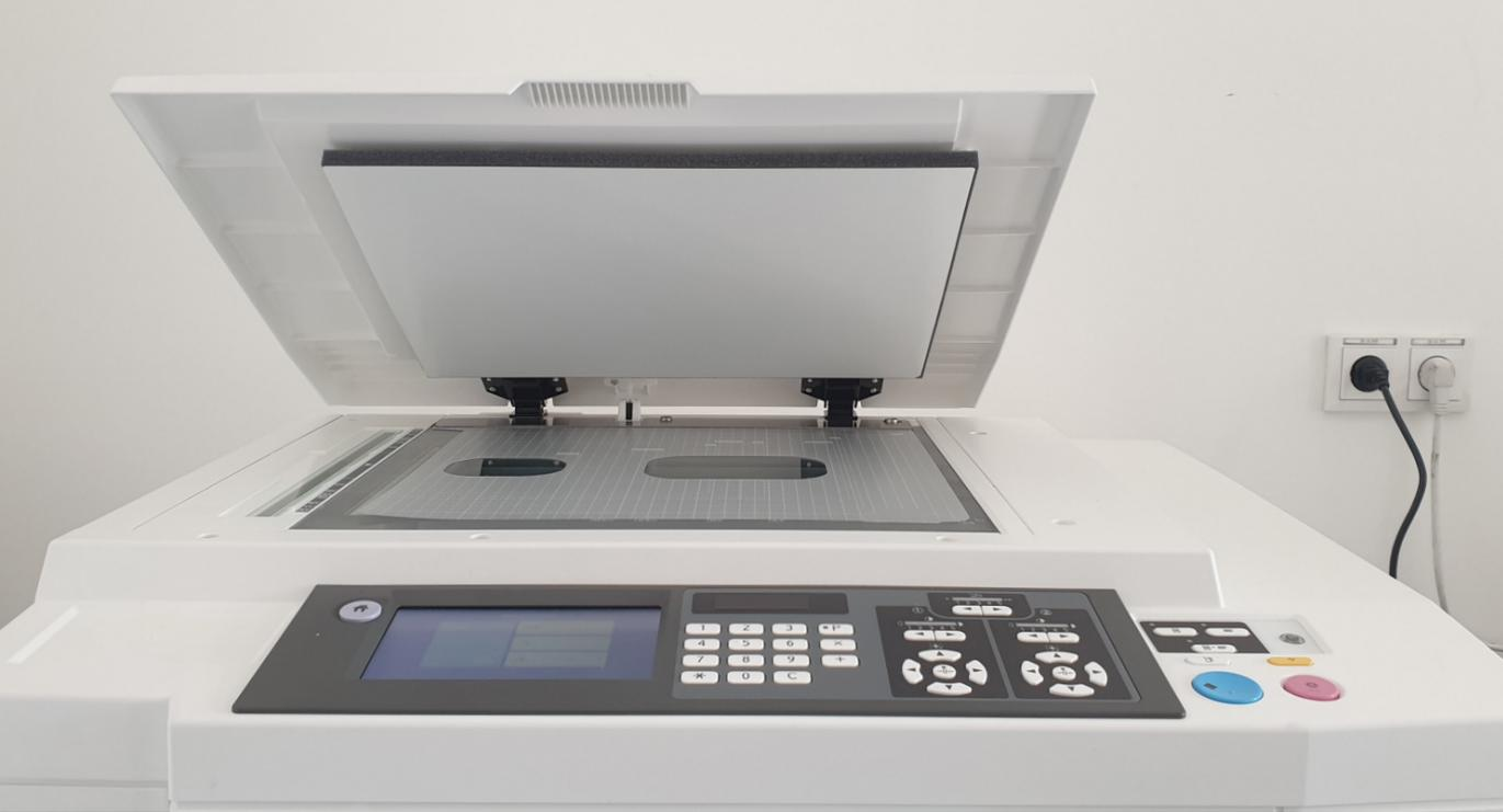
Abbildung 83: Scaneinheit des Risographens (Eigene Grafik)
