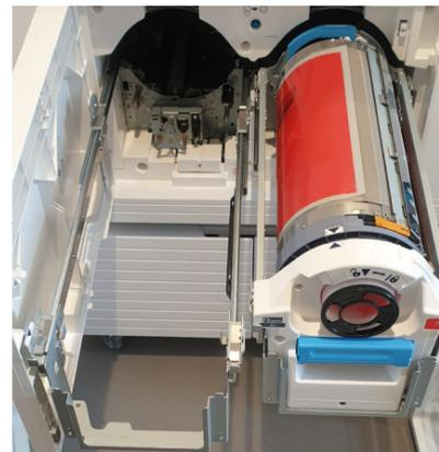
Abbildung 71: Leere Farbtrommel-Schiene (Eigene Grafik)
