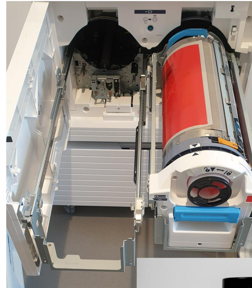
Abbildung 32: Ausgefahrene Schiene des Risographen (Eigene Grafik)
