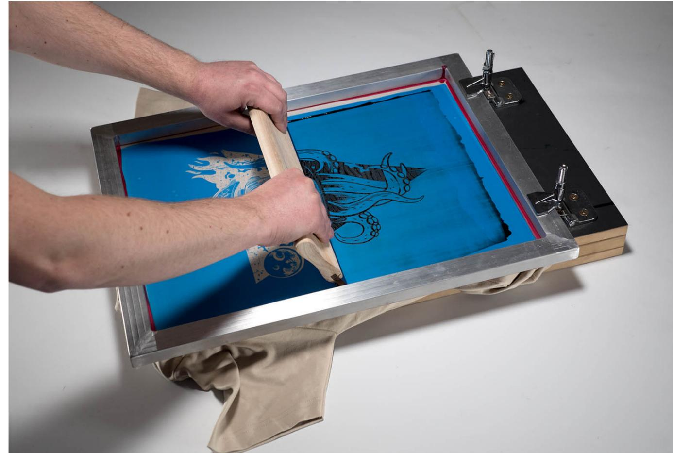
Abbildung 11: Siebdruckverfahren (Quelle: Siebdruckland)
