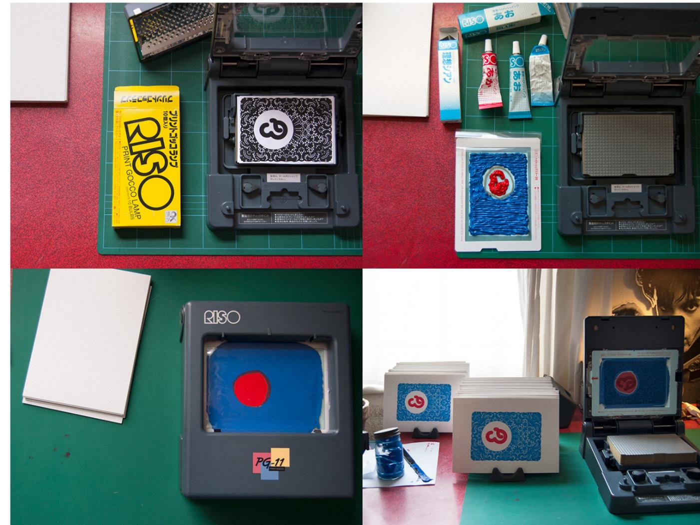
Abbildung 28: Workflow Print Gocco 11 (Quelle: Maraid Design, 2009)
