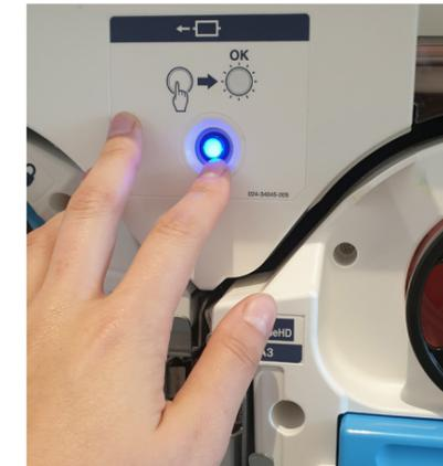
Abbildung 69: Farbtrommeln entriegeln (Quelle: Eigene Grafik)
