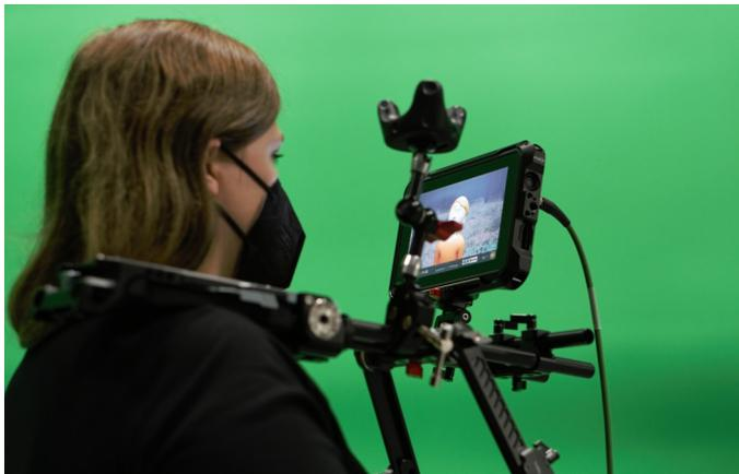
Abbildung 12: Kamera Rig. Simple Kamera Setup welches mit einem HTC-Vive Tracker arbeitet. Das Kamera Rig besteht lediglich aus Vive-Tracker und Monitor, da ausschließlich in einer virtuellen Umgebung gefilmt wird.
