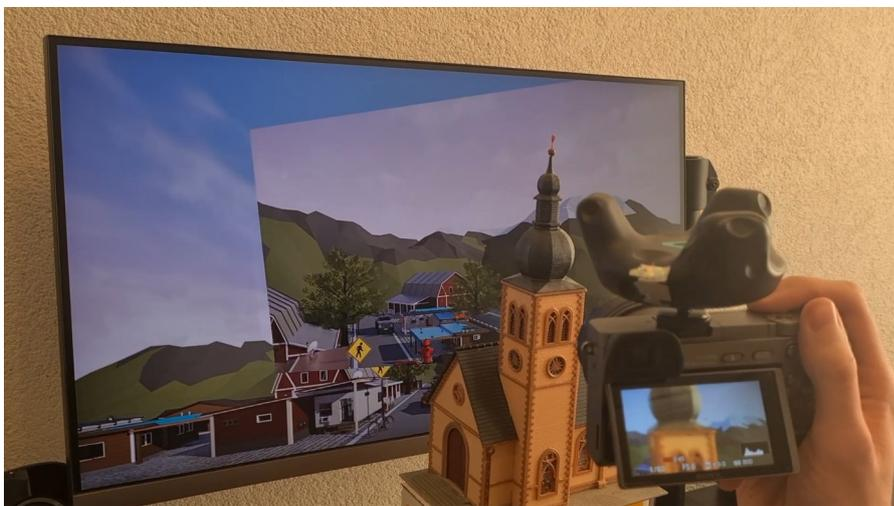
*Abbildung 13: Improvisierte LED-Wall. Ein Virtual Production Setup mit einem handelsüblichen 28 Zoll Monitor.*
