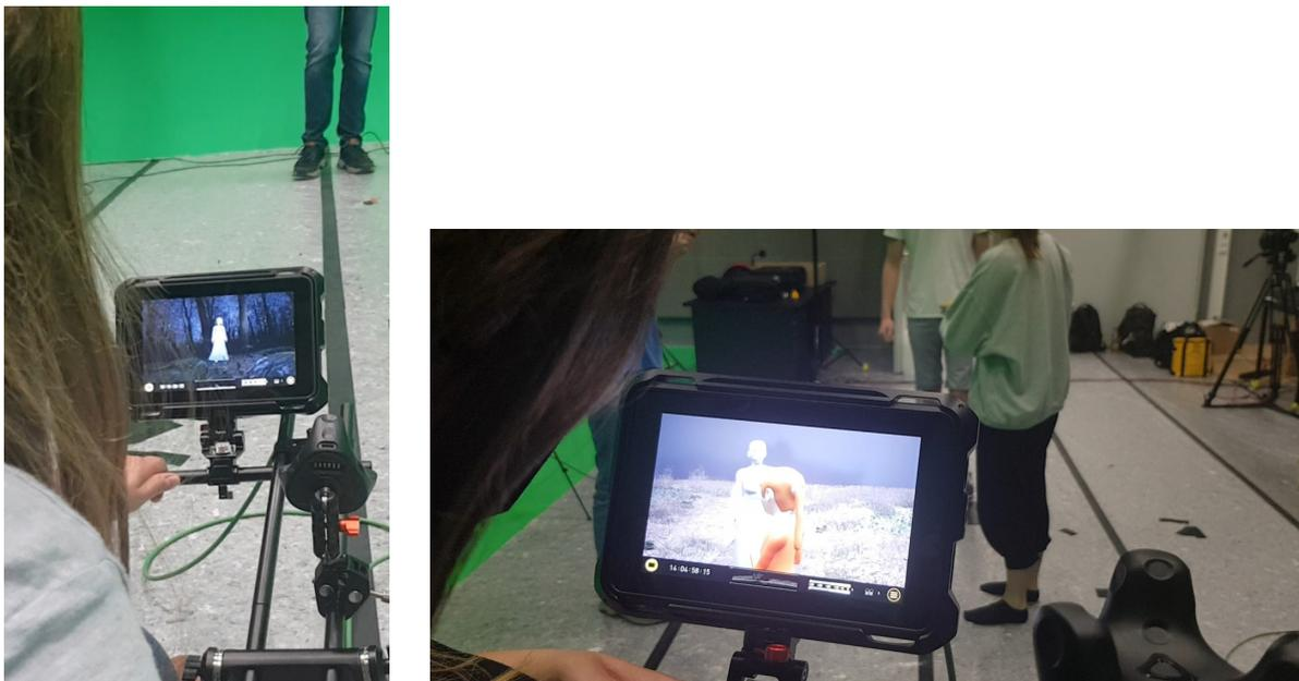
Abbildung 25 & 26: Kamera Rig mit VIVE Tracker - Quelle: Eigene Abbildung
