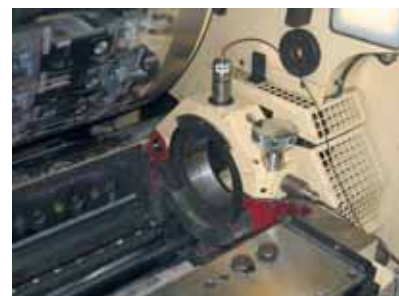
Ausschnitt aus einem Stahlstichdruckwerk Rechts: Anbringung zweier Akustik-Sensoren
