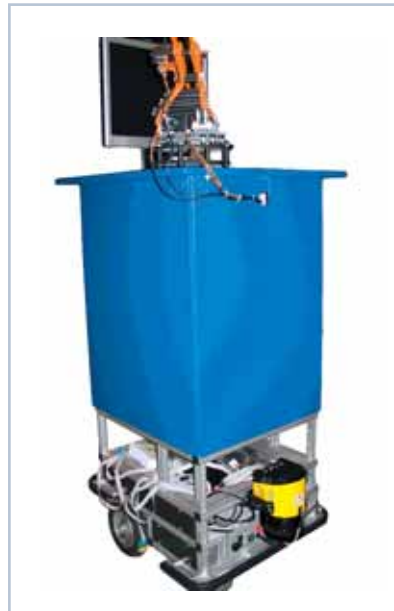
Ergänzung der Profibot-Plattform mit einem Abstandssensor und einem Plattform-Aufbau für Präsentationszwecke
