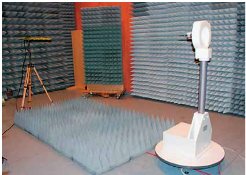
Reflexionsarme Schirmkabine mit OTA-Messplatz
