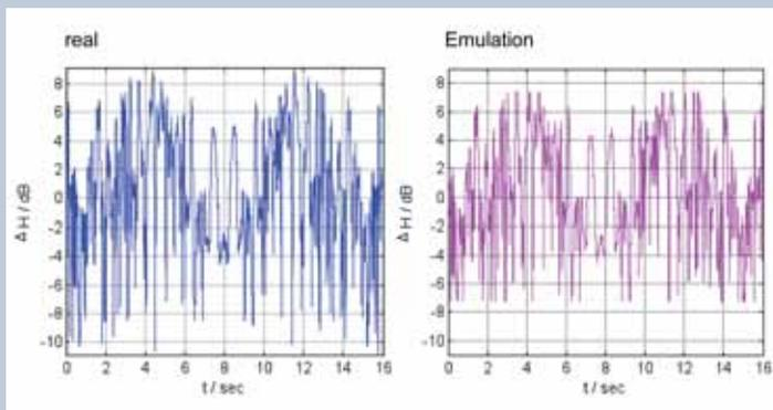
*Zeitabhängiger Übertragungsfaktor einer Roboterapplikation.*
