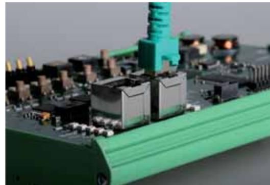
*FPGA-basierte Implementierung eines Echtzeit-Ethernet Knotens*
