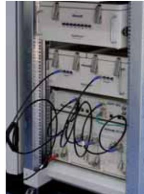
*Testsystem für Messungen an WLAN-basierten Netzwerken
