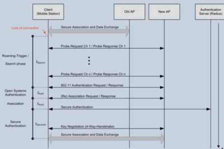
Ablauf eines Zellwechsels in 802.11 WLANs
