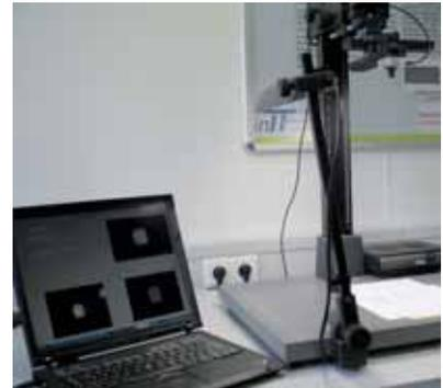
Bildverarbeitungsdemonstrator für die Oberflächenanalyse
