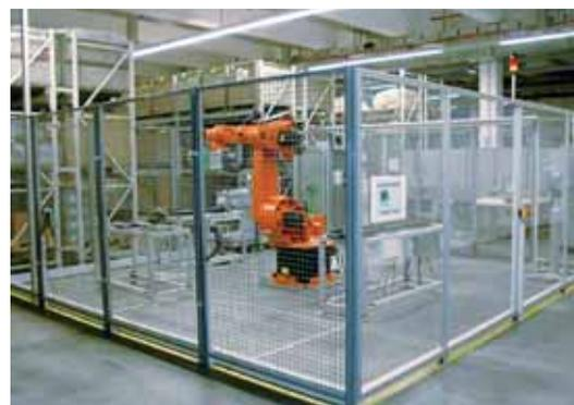
Roboterzelle mit zwei Förderbändern
