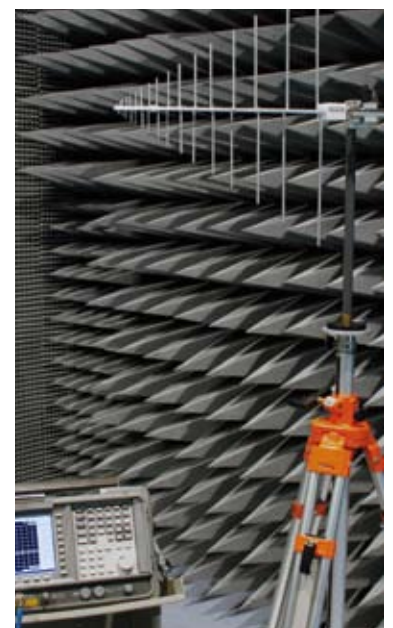
Begehbare Abschirmkabine Walkable anechoic chamber
