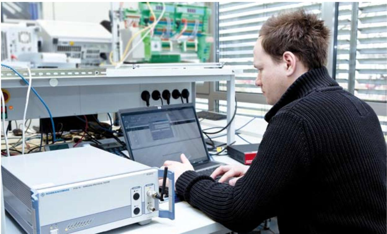
auf ihre Leistungsfähigkeit, Interoperabilität und Konformität zu untersuchen. Ein WLAN Client-Emulator dient der Realisierung größerer Netzwerke, ohne hierfür eine entsprechend große Anzahl physikalischer Geräte nutzen zu müssen. Er kann bis zu 64 virtuelle WLAN-Clients nachbilden. Zusammenfassend werden die folgenden kommerziellen Testlösungen für den drahtlosen Bereich eingesetzt:
