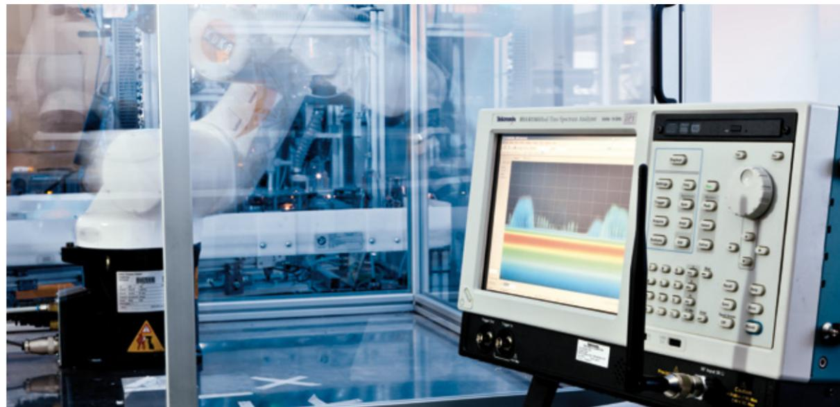
Standardkonformität eines industriellen Ethernet Switches von IXXAT. Hierzu wurden standardisierte Testverfahren aus dem Internet-Umfeld herangezogen (RFC 2544 und RFC 2889) und mit einem entsprechenden Testsystem umgesetzt.
