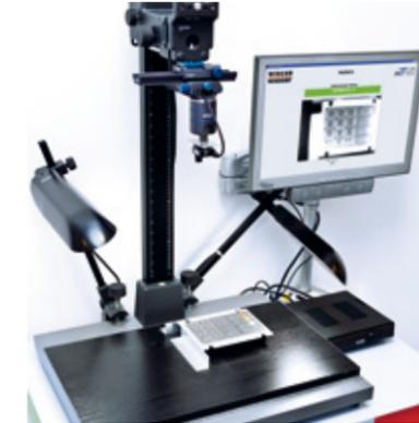
5. Messsystem für Keypad / Measuring system for keyboards
