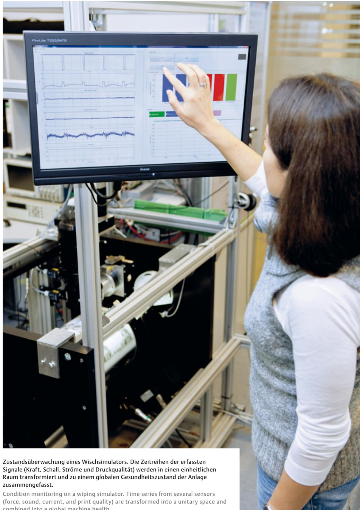
Zustandsüberwachung eines Wischsimitators. Die Zeitreihen der erfassten Signale (Kraft, Schall, Ströme und Druckqualität) werden in einen einheitlichen Raum transformiert und zu einem globalen Gesundheitszustand der Anlage zusammengefasst.
