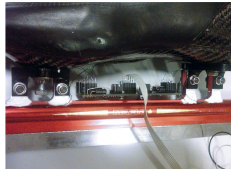
Schlittschuh mit montierter Auswertungselektronik
