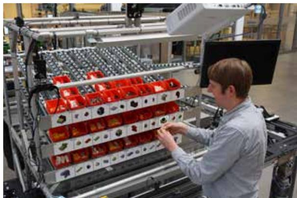
Die projektionsbasierte AR-Umgebung wird am wandlungsfähigen Montagesystem der SmartFactoryOWL getestet.
