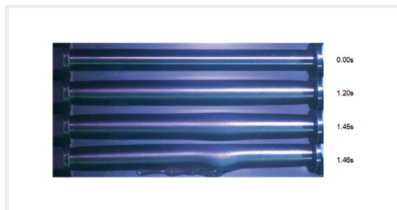
Deformation eines Rohres während der Burst-Druckprüfung innerhalb von ca. 1,5 Sekunden
