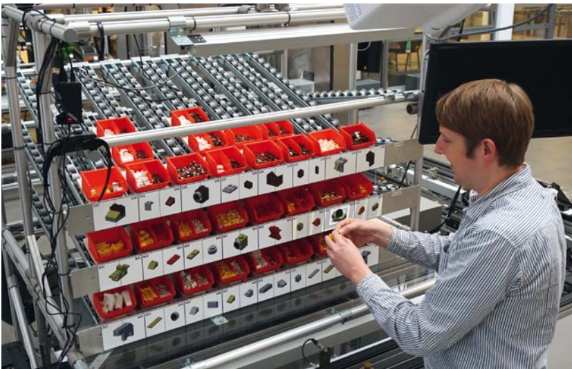
Projektionsbasierte Augmented-Reality-Systeme projizieren Arbeitsanleitungen in den physischen Arbeitsplatz ihrer Nutzer
