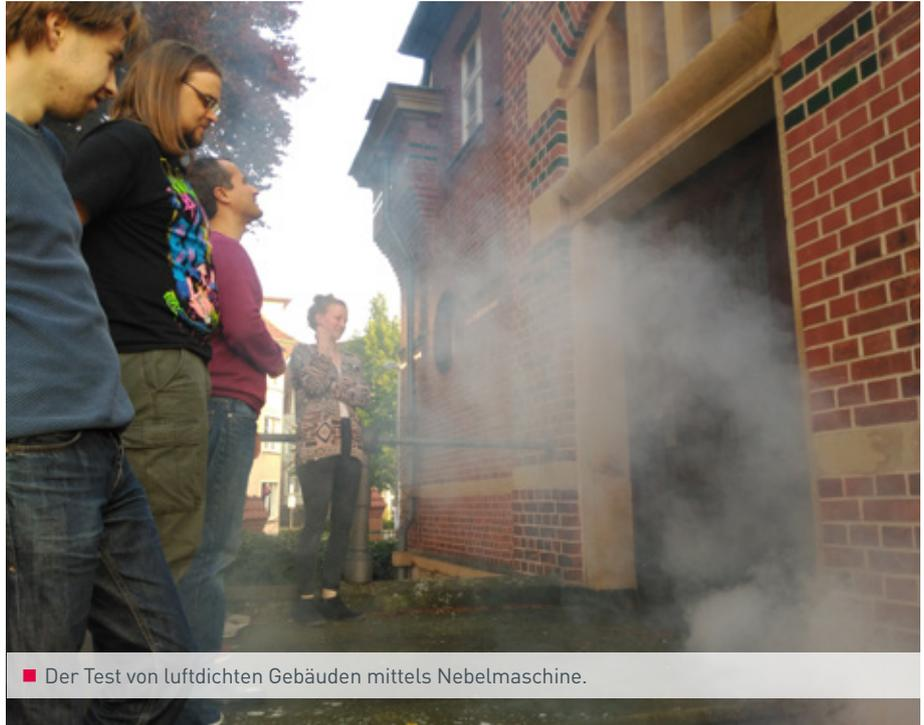
■ Der Test von luftdichten Gebäuden mittels Nebelmaschine.
