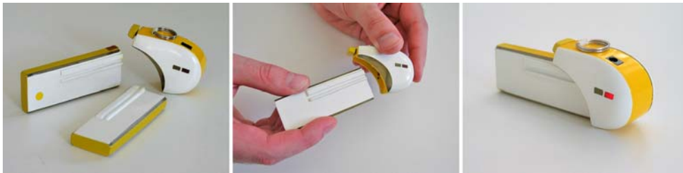
Abbildung 3: Personal Aura: Lesemodul mit zwei ID-Modulen (links), Aktivierung durch Zusammenstecken von ID- und Lesemodul (Mitte) und aktivierte Personal Aura (rechts).
