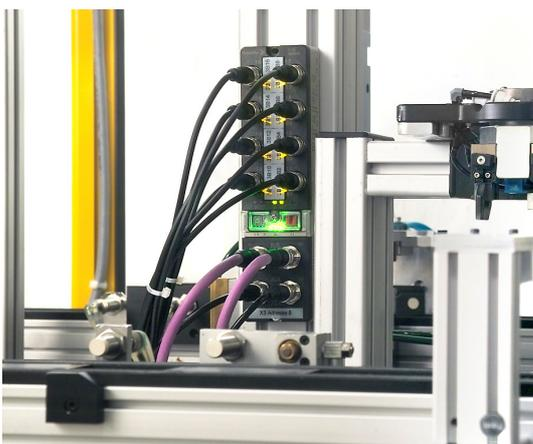
Abb. 1: Kabelgebundenes Sensor-Aktor-Interface (SAI) in einer Automatisierungsapplikation
