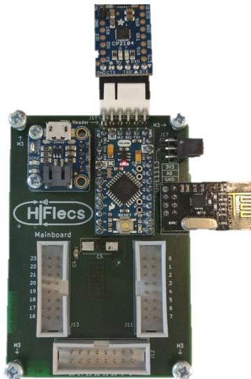
Abbildung 41: Mikrocontroller-Mainboard mit dem LiPo Charger (oben links), dem Mikrokontroller Arduino Pro Mini 328 (mittig), dem Transceiver NRF24L01+ (rechts) und den LED-Leisten-Schnittstellen (unten)
