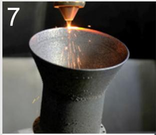
7 Laseraufbau des konischen Trichters
