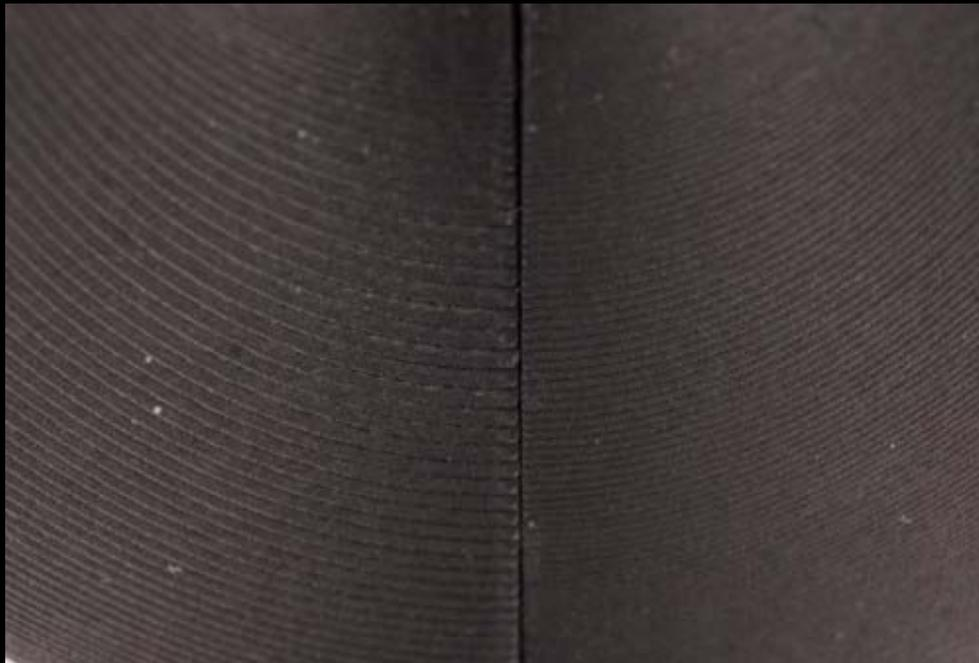
Mit einer Schichtstärke von 0,05 mm erhalten Ihre Bauteile eine perfekte Oberfläche und ähneln in Optik und Haptik einem Spritzgussbauteil.
