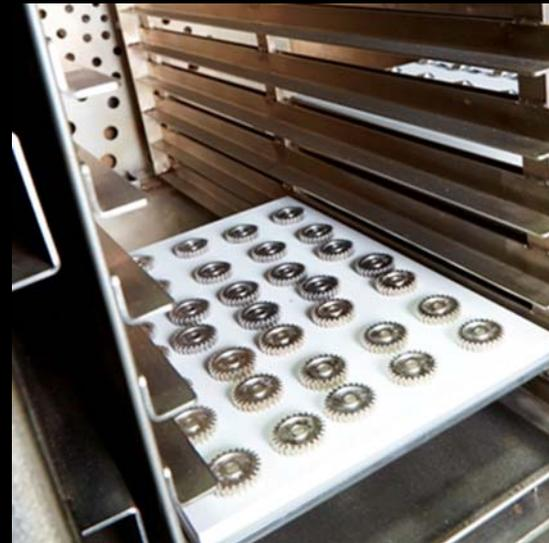
Der Kunststoff wird entfernt und die Bauteile im bewährten Prozess gesintert.
