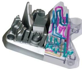
Konturnahe Kühlung eines Werkzeuges; Quelle: Renishaw
