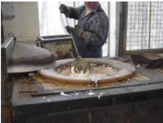
Abbildung 6-6: Abschöpfen der Aluminiumoxidschicht
