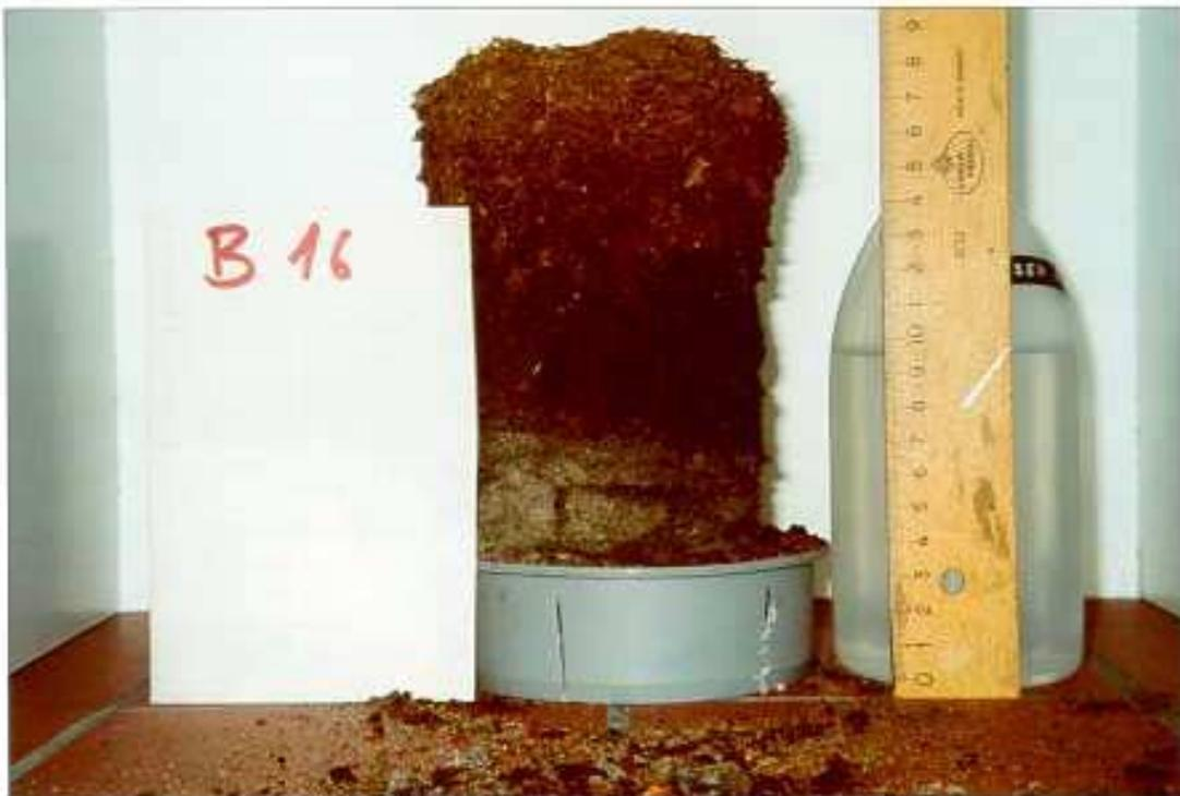
Abbildung 3-4: Inhalt einer Buchensäule, die Probenbezeichnung B16 stammt aus Vorversuchen
