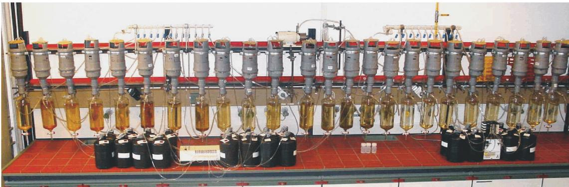
**Abbildung 3-1: Anlage zur Beregnung von 24 Bodensäulen mit unterschiedlichen Aufgabelösungen**
