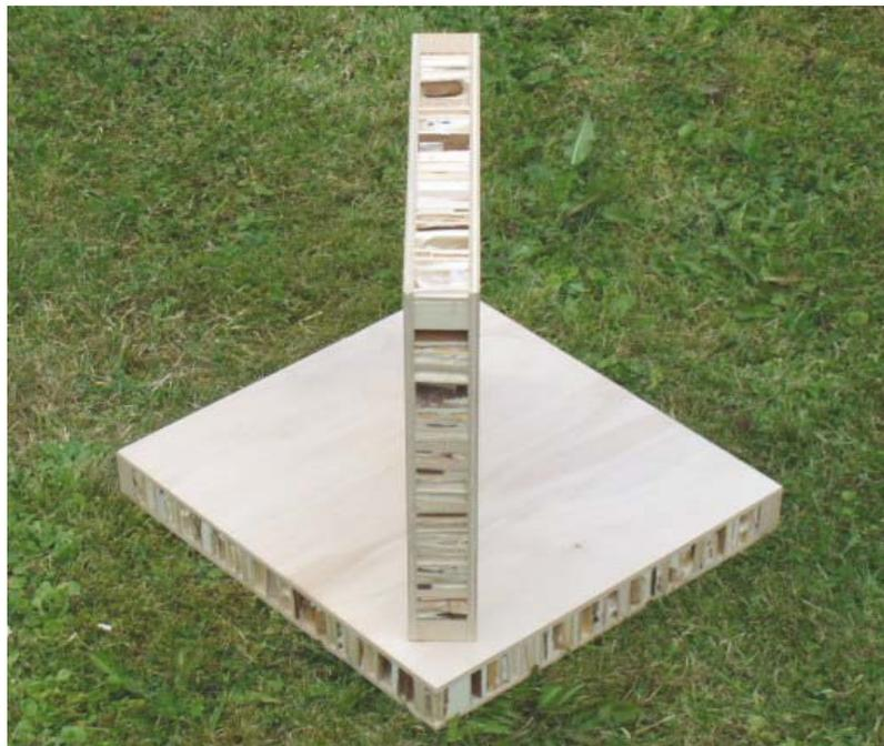
**Abbildung 11-4: LNS-Plattenmaterial der Firma Böker Sperrholz**
