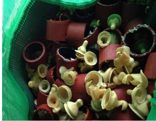
Abbildung 11: Mischung 2:1 Gummiadsorbens und Latexadsorbens
