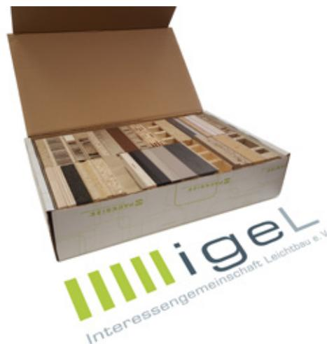
Einer von 150 igeL-Musterkoffern mit über 35 Leichtbauplattenwerkstoffen, von denen knapp die Hälfte an der Hochschule in Lemgo formatiert wurde.
