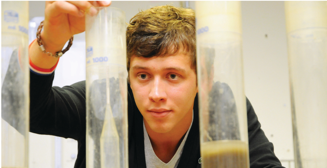
Mit dem Aräometer die Wasserdichte bestimmen gehörte für Felix Wegner zur Ausbildung als Baustoffprüfer.
