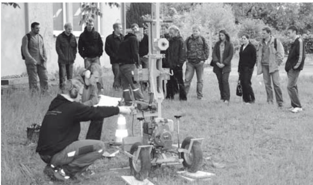
Baugrundprüfung mit der Rammsonde: die Schläge geben Aufschluss zur Tragfähigkeit des Bodens.
