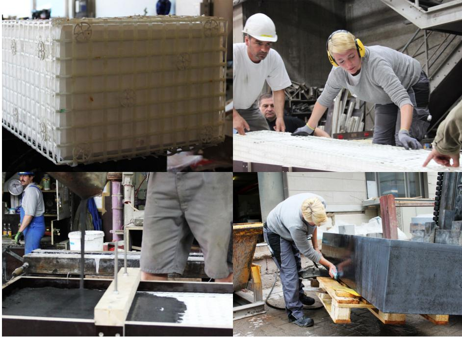
Zur Bewehrung verwendeten wir einen Glasfaserkorb der Firma Solidian, dieser umschloss einen Styropor®-Kern. Gegossen wurde der Block bei Kronimus in Iffezheim mit FLOWSTONE®-Beton.
