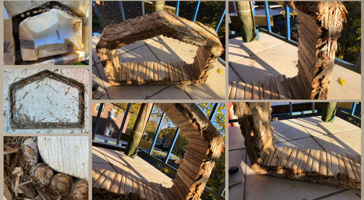
Einschalung mit aufrecht stehenden Typhahalmern
