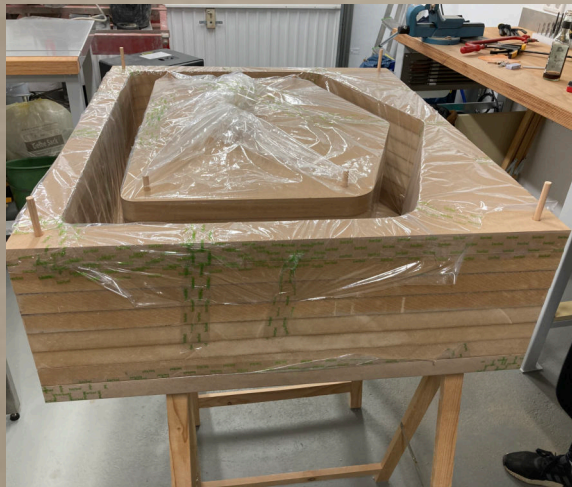
Holzschalung mit Folie einkleiden
