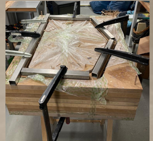
mit Schraubzwingen gleichmäßig verpressen und trocknen lassen
