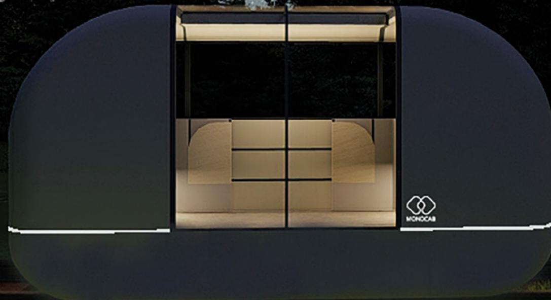
Im Oktober 2020 startet unter Federführung der TH OWL das regionale Forschungsprojekt „MonoCab“. Darin wird ein neuartiges Transportmittel entwickelt, das bestehende Bahnschienen nutzt, aber auf nur einer Schiene fahren wird. Das hat den Vorteil, dass so ein kurz getakteter Pendelverkehr mit einander begegnenden Cabs möglich ist.
