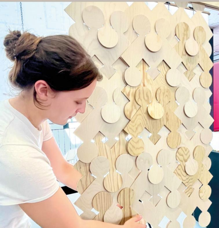
Talke Lüttmann entwickelt eine erweiterbare Holzoberfläche, bei der immer gleiche Grundmodule miteinander verschränkt werden.
