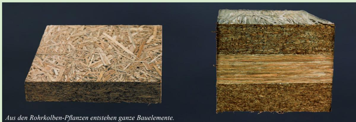
Aus den Rohrkolben-Pflanzen entstehen ganze Bauelemente.
