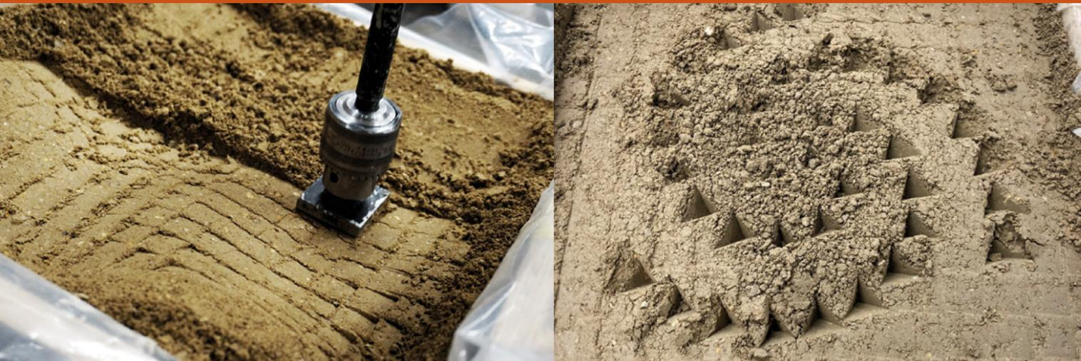
Verschiedene Bearbeitungswerkzeuge werden am Roboterarm angebracht.
