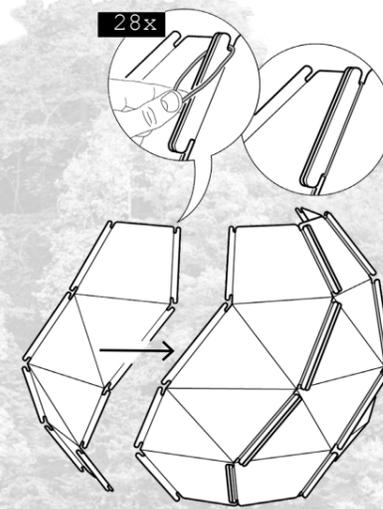
Schritt 1 wird solange wiederholt bis alle acht Elemente eine Kugel bilden. Ein Element hat ein Loch, dies ist die Öffnung für den Vogel.
