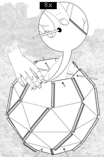
Im Schritt 3 werden die Öffnungen oben und unten mit den Strohhalmen geschlossen. Sie belüften das Häuschen und ermöglichen ein leichtes Reinigen. Der Innenausbau der Vögel kann auf den Strohhalmen aufgebaut werden.
