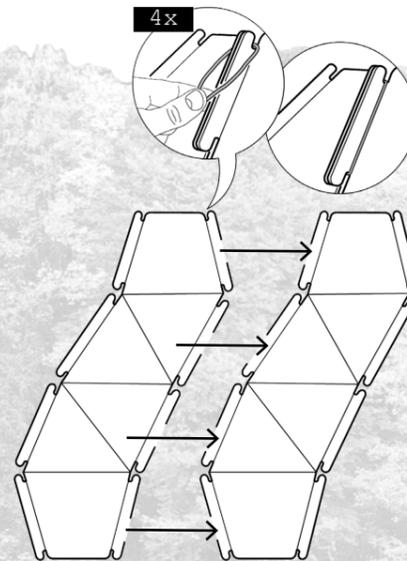
Im ersten Schritt soll verdeutlicht werden, wie die acht Elemente mit Hilfe eines Gummibandes verbunden werden.
