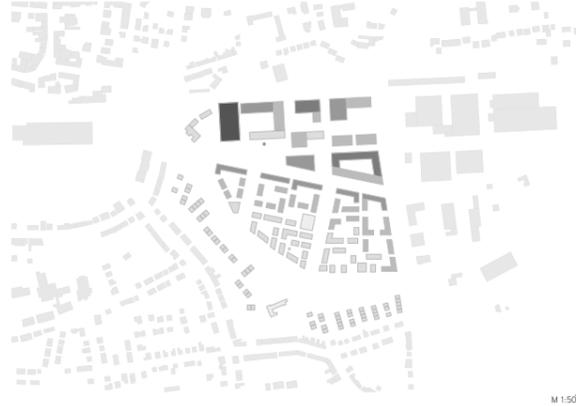
Die Bebauung des Quartiers entwickelt sich von vier-geschossiger Baustruktur im Norden und entlang der Südtangente mit Gewerbe sowie Mischnutzung zu geringerer Höhe im Süden. Das Gebäude direkt am Platz ist mit zwei Geschossen tiefer gehalten, um eine ausreichende Belichtung für den Freizeitcampus zu erzielen.
