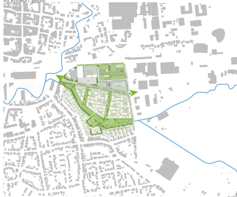
Im Bestand gibt es trotz der Nähe der Innenstadt großflächige Gewerbebauten. Die Fläche ist fast komplett versiegelt und zum Teil auch ungenutzt und dadurch brach liegen. Diese Flächen sind im Entwurf mit Nutzungen versehen, sodass keine Räume unnötig versiegelt sind.
