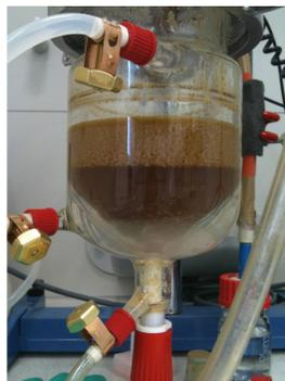
Ein Beispiel für eine enzymatische Hydrolyse ist der Abbau von Schlachtabfällen, die mit einem Fleischwolf zerkleinert, und mit Leitungswasser auf Fließkonsistenz eingestellt wurden.
