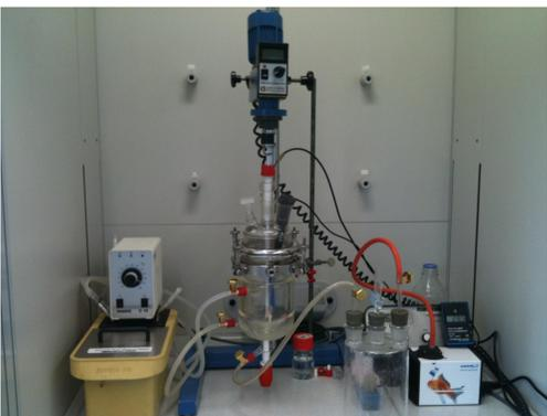
Als Hydrolysereaktor wurde ein 1000 ml Doppelmantelbehälter mit Bodenablauf und Schliffdeckel verwendet.
