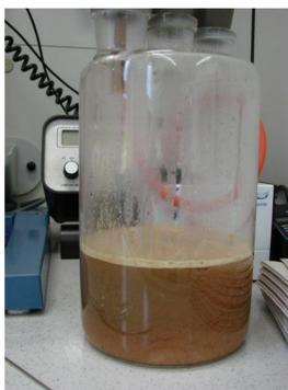
Um ein möglichst reines Hydrolysat zu erhalten, musste das gewonnene Produkt gefiltert werden. Dabei wurden die übrigen Gewebereste abgetrennt.
