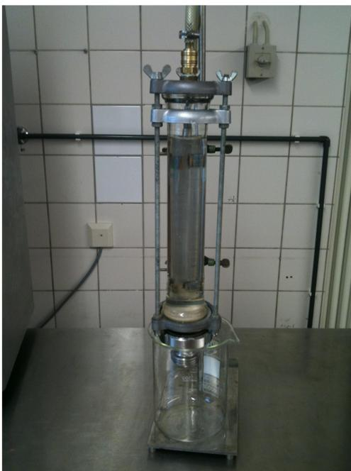
Zur Abtrennung der nicht aufschließbaren Biomasse nach erfolgter enzymatischer Hydrolyse wurde eine Druckfiltrationsanlage installiert, die mit verschiedenen Filtereinlagen ausgestattet werden kann, und bis zu 8 bar Überdruck betrieben werden kann.
