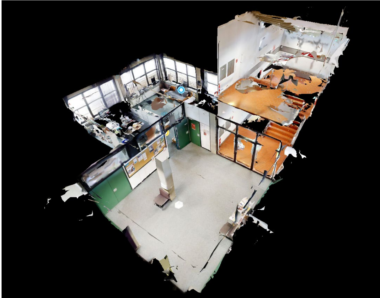
Abb. 3: Resultierendes 3D-Modell des beschleunigten Scannverfahrens. „Kap05_Abb03_LocationScan.tif“
