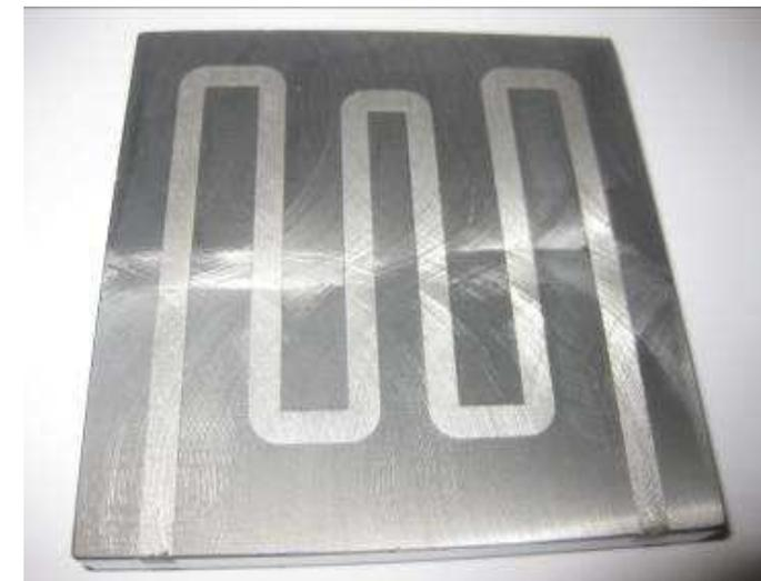
Bauteil mit Kühlkanal (Schnitt)
