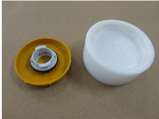
Das Einschrauben von Deckeln auf die Einfüllstutzen von Spülmitteln in der Montage erfordert einen hohen manuellen Kraftaufwand. Daher wurden zur Entlastung der Mitarbeiter bereits passende Schraubköpfe zur Verfügung gestellt. Diese wurden spanend hergestellt und sind dementsprechend kostenintensiv.
