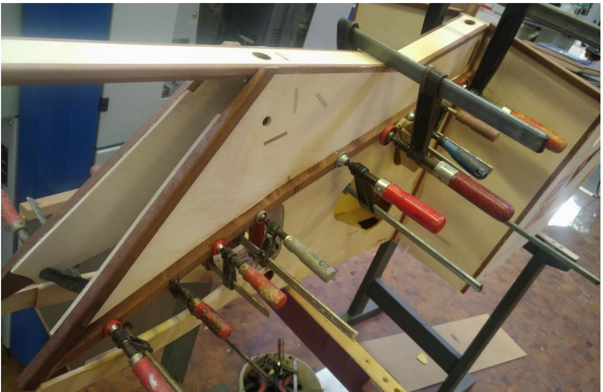
Biegen und Verklebung der Diagonalstrebe
