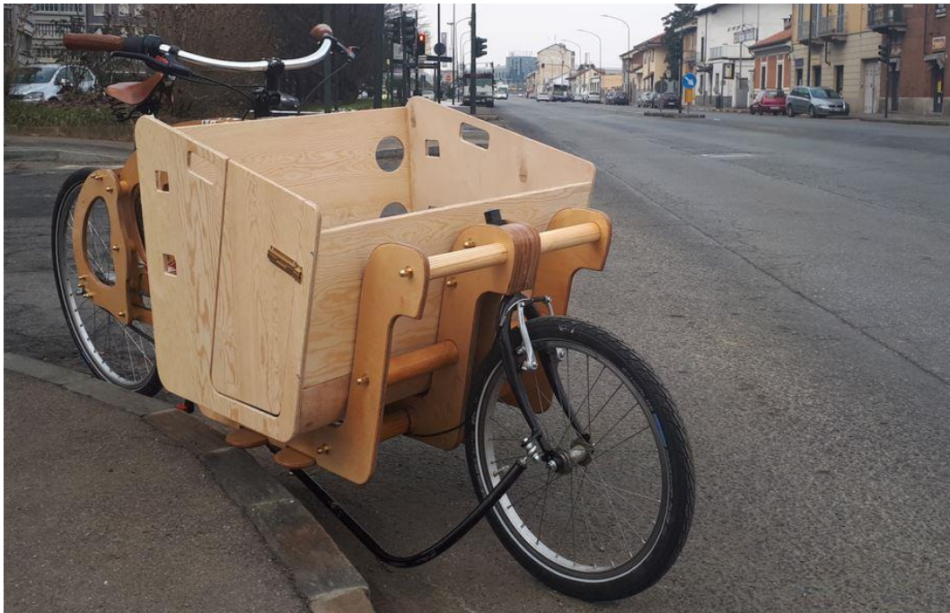
Abbildung 10: Lastenfahrrad aus Birke-Multiplex
