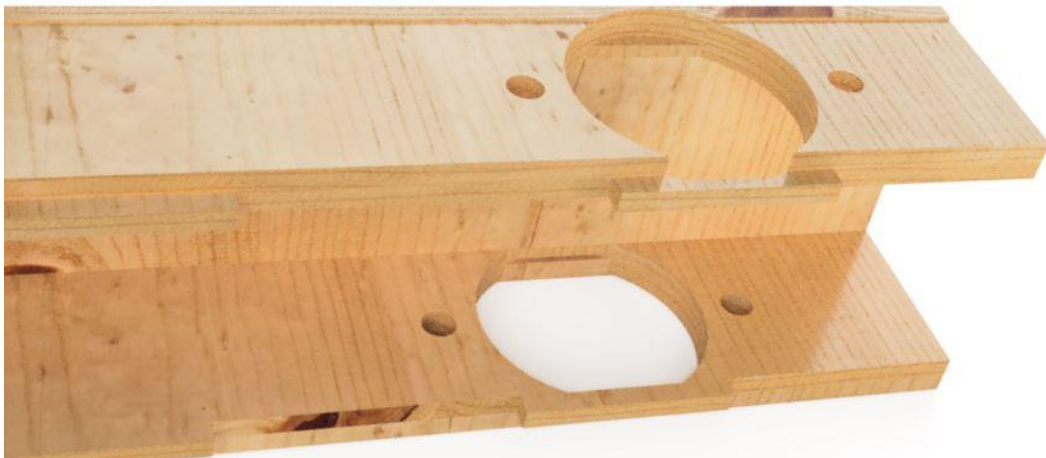
Abbildung 23: Bohrungen im Holm des Lastentrikes für die Positioniergenauigkeit der geflanschten Kugellagereinheiten
