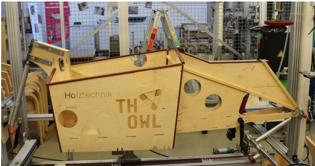
Abbildung 36: Dynamische Prüfung des Rahmens mit einer vertikalen Kraft auf der Sattelstütze im Prüfstand
