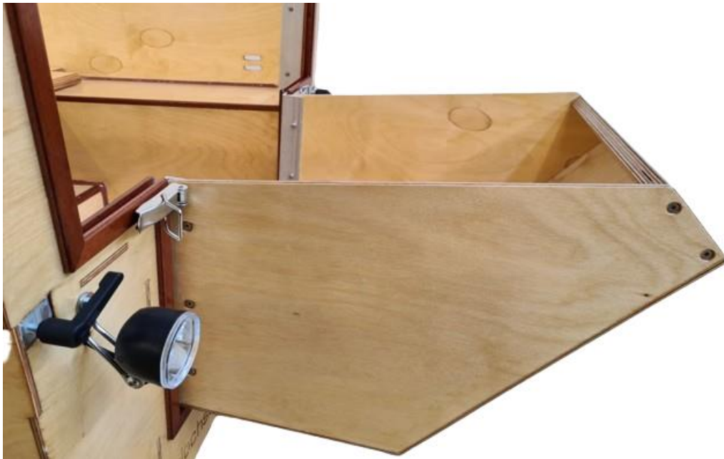
Abbildung 17: Austauschbare Fußstütze des Lastentrikes für den Transport von Erwachsenen
