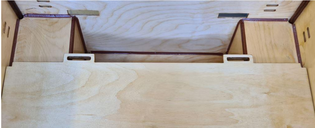
Abbildung 27: Lösbare Verbindung der Sitzfläche
