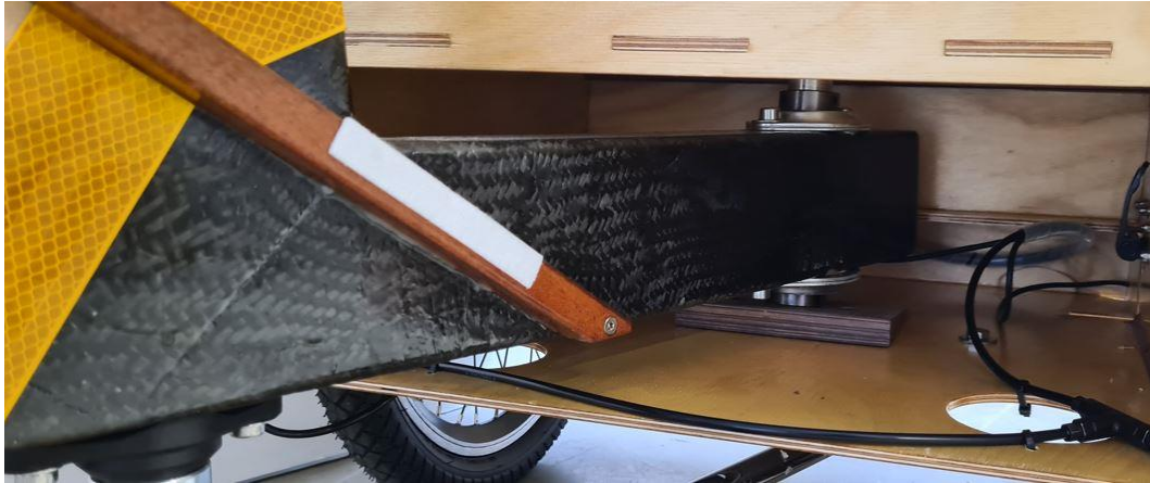
Abbildung 22: Verstärkung des Holms des Lastentrikes mit CFK
