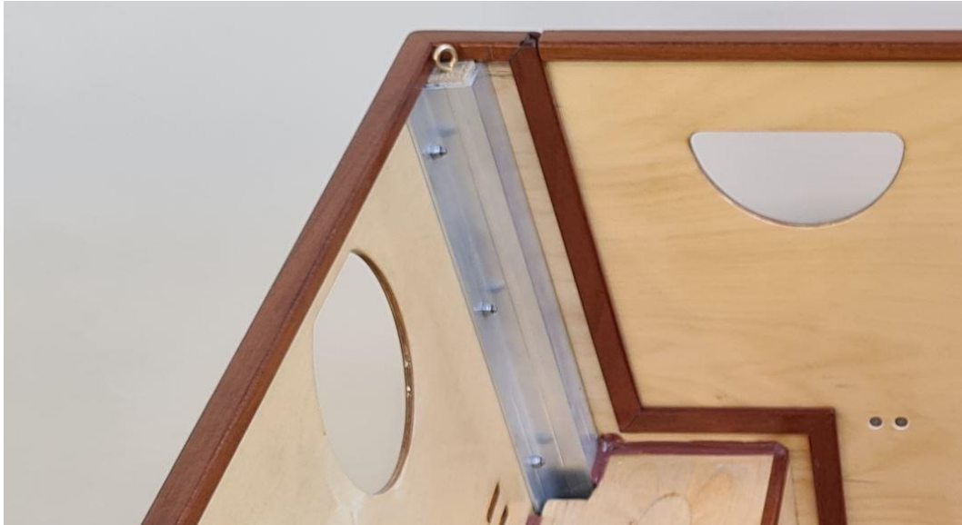
Abbildung 28: Aussteifung der Transportkiste mit einem Aluminium-Profil
