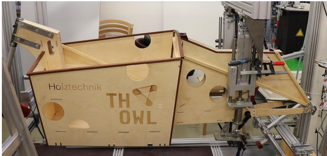
Abbildung 32: Dynamische Prüfung des Rahmens mit pedalerenden Kräften im Prüfstand
