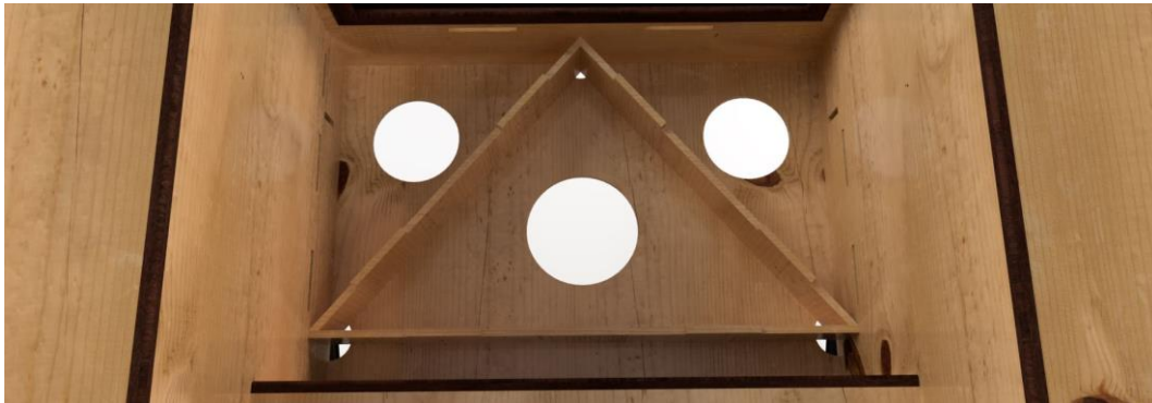
Abbildung 20: Gewichtsreduzierung zwischen Ober- und Unterboden der Transportkiste durch Verrippungen
