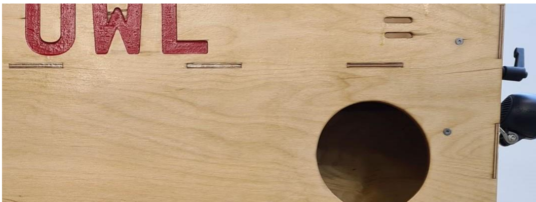
Abbildung 18: Zapfenverbindung zwischen Vorderstück und Radkastendeckel
