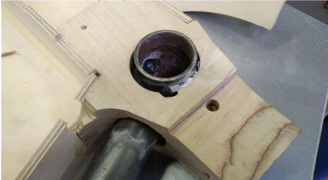
Abbildung 26: Hohlraum im Tretlagerblock zwischen Sattelstange und Tretlager
