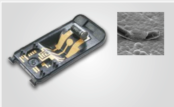
Bestücktes Bauteil. Bild rechts: Bondfuß auf stromlos metallisiertem Pad mit Cu/Ni/Au.
