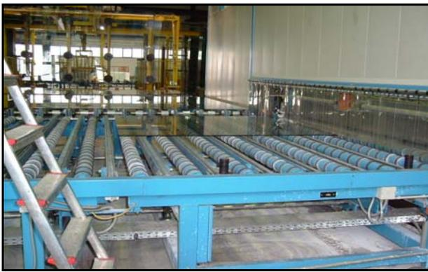
Abbildung 5-14: Einschleusung des Floatglases in die Sputteranlage
