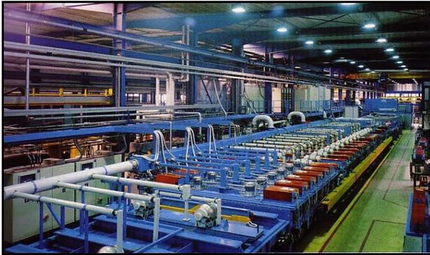
Abbildung 5-13: Sputteranlage im Hause Interpane, Lauenförde
