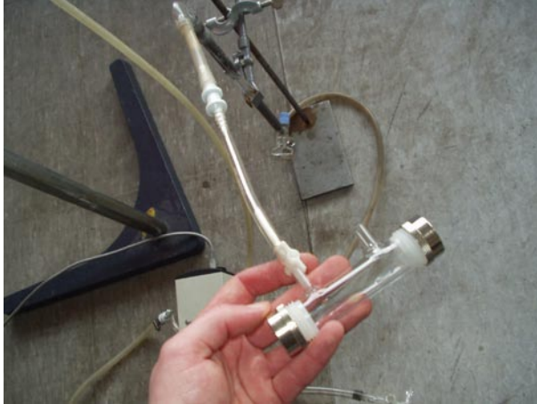
Abbildung 5.9: Probenahme mittels Gasküvette
