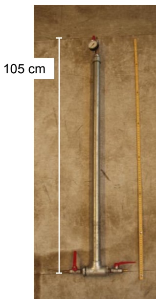
Abbildung 5.19: eingesetzter Überdruckreaktor mit Molekularsiebfüllung
