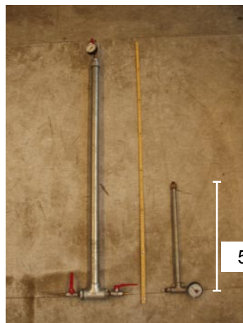
Abbildung 5.25: Überdruckreaktor der Vorversuchsreihe mit Nickel Pulver; Vergleich Überdruckreaktor groß und klein
